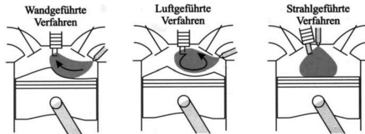
Abbildung 2.2: Brennvorgänge bei der Benzin-Direkteinspritzung [68]
