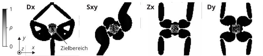
Abbildung 5.7: Topologielösungen für verschiedene Zielspannungsvorgaben der IZS-Formulierung in Variante 2 nach 1000 Iterationen, ohne Nebenbedingung g_s für versagenskritische Spannungen [63]
