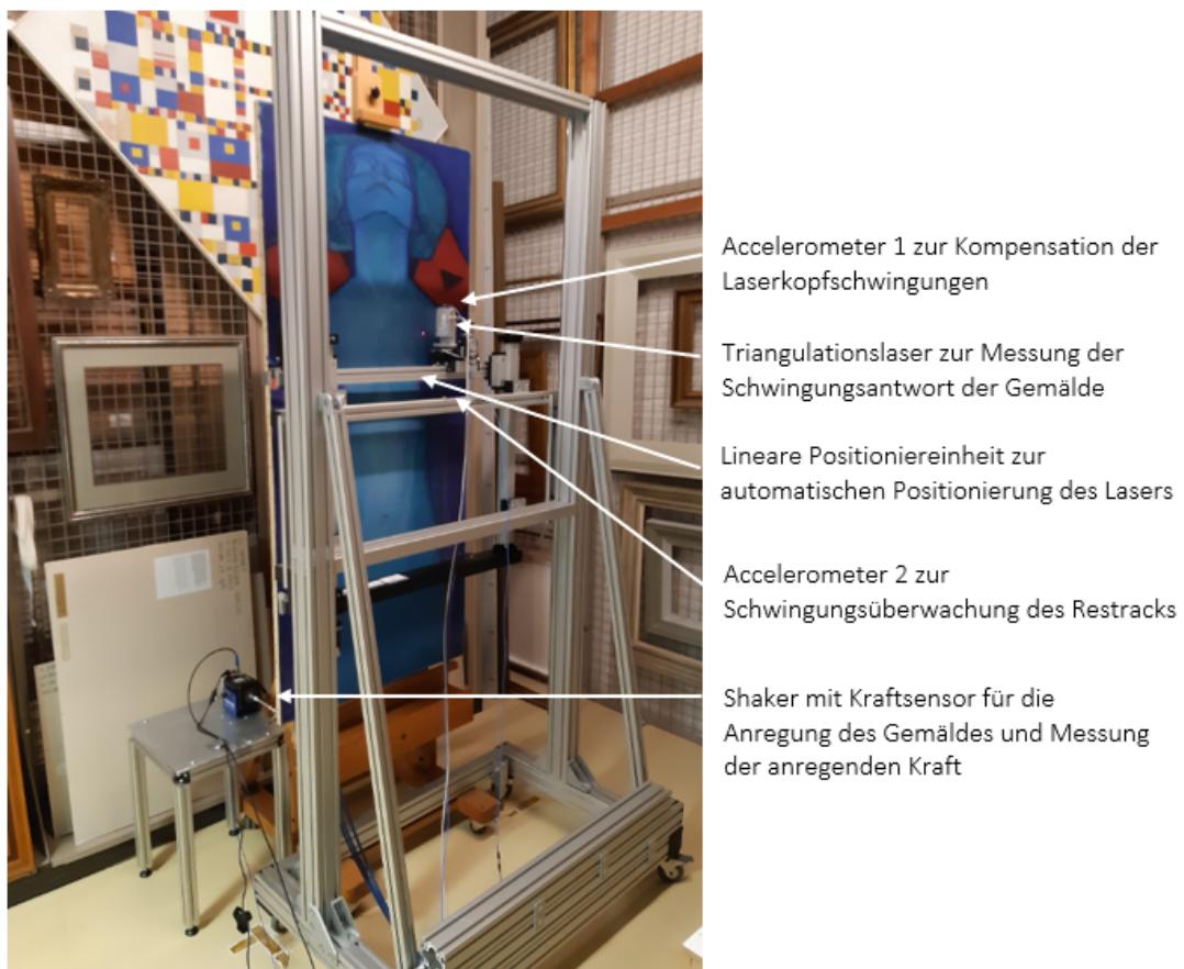
Abb. 248: Versuchsaufbau zur Messung des Schwingungsverhalten der Gemälde
