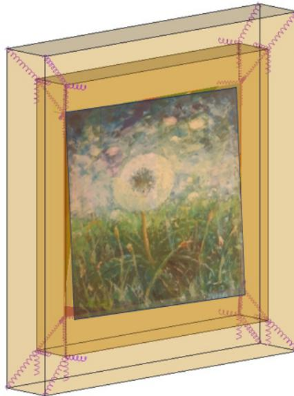
Abb. 139: FEM-Geometrie einer doppelwandigen Holzkiste mit innen befindlichem Gemälde
