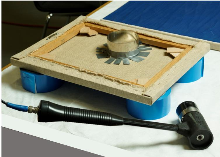
Abb. 36: Versuchsaufbau zur Risseinbringung an der Rückseite von D6
