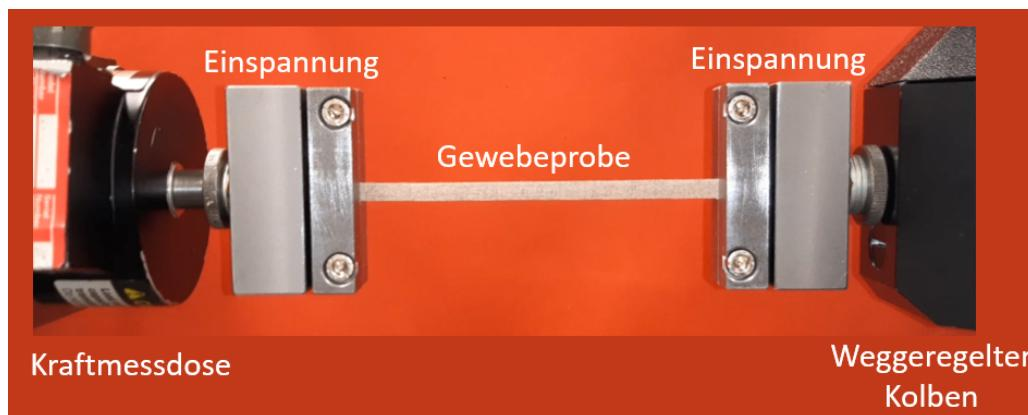
Abb. 58: Versuchsaufbau für Zugtests an beschichteten und unbeschichteten Gemäldeproben
