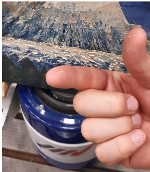
Abb. 83: Beispiele für verlustige Farbflocken von Testgemälde 3 während der DST
