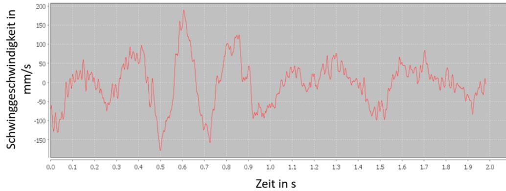
Abb. 144: Schwinggeschwindigkeiten der LKW-Ladefläche in vertikaler Richtung
