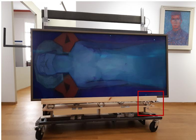
Abb. 254: Linkes Gemälde auf schwingungsisoliertem Gemäldetransportwagen
