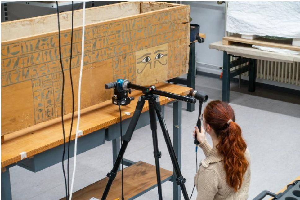
Abb. 183: Versuchsaufbau für die Modalanalyse an dem Kastensarg ohne Deckel
