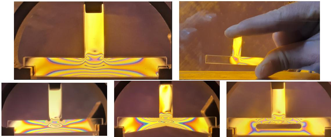
Abb. 212: Spannungsoptische Untersuchungen
