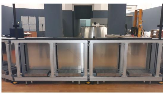
Abb. 267: Frontalansicht des Rahmenwerks des schwingungsisolierten Sockels
