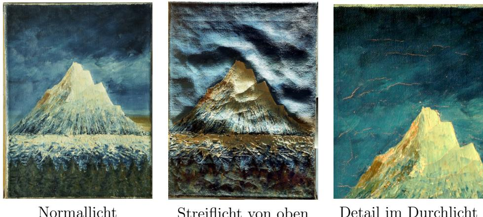
Abb. 32: Verschieden beleuchteter Gemäldedummy F (Testgemälde 3 in Konfiguration 2) mit ausgeprägtem Craquelé und Deformationen nach einer mißglückten Doublierung [84], Fotos: D. Hedinger
