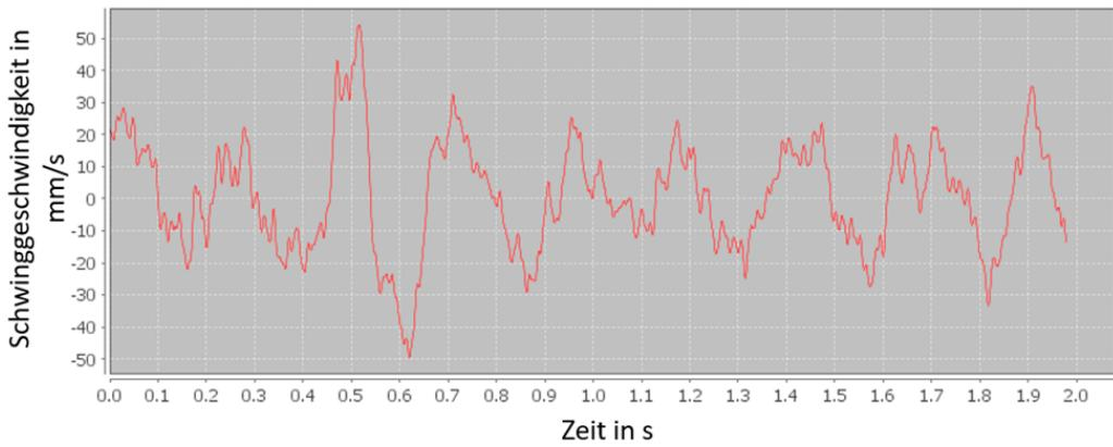
Abb. 142: Schwinggeschwindigkeiten der LKW-Ladefläche in lateraler Richtung (in Fahrtrichtung)
