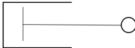
Abb. 6: Newton-Element, Quelle:[20], S. 18
