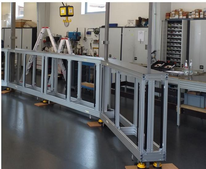
Abb. 269: Seitenansicht des Rahmenwerks des schwingungsisolierten Sockels
