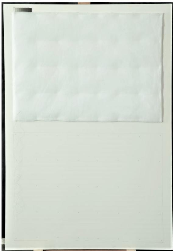
Abb. 232: Rückseite des Rückseitenschutzes mit angenähertem Schwingsschutz (Polyestervlies)
