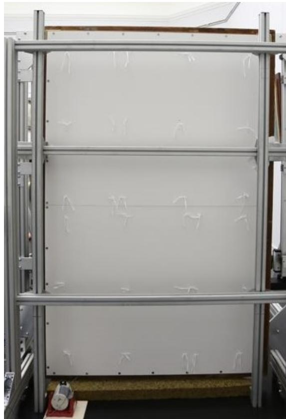
Abb. 233: Rückseite von Beckmann's „Fastnacht“ Rückseitenschutz während der Schwingungsmessungen
