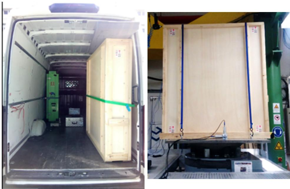
Abb. 134: Typische Befestigung von Kunsttransportkisten an der Boardwand (links), Befestigung einer Transportkiste auf einem Shaker für eine Transportsimulation (rechts)
