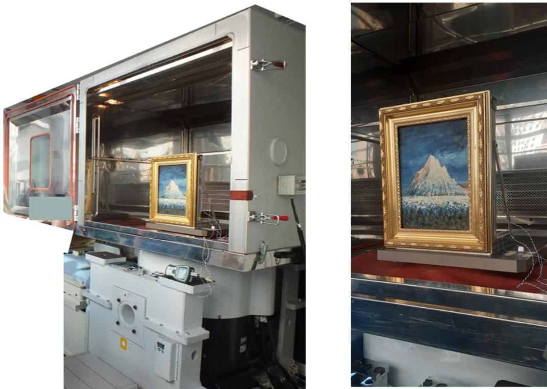
Abb. 52: Testgemälde **F** in der Klimakammer (AUCOTEAM GmbH, Berlin) für den kombinierten Klima-Vibrationstest
