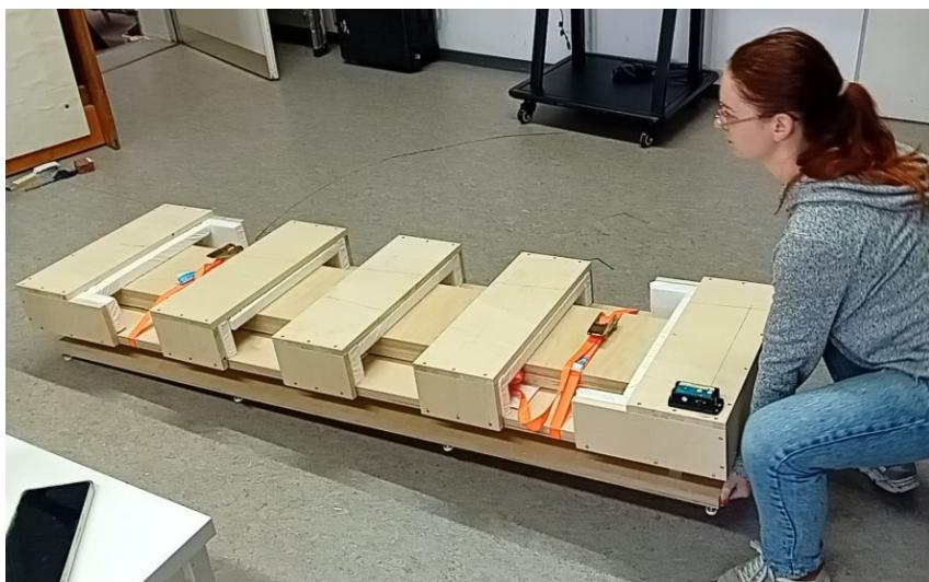
Abb. 188: Seitenkantenfalltest zur Qualitätssicherung und Risikomanagement
