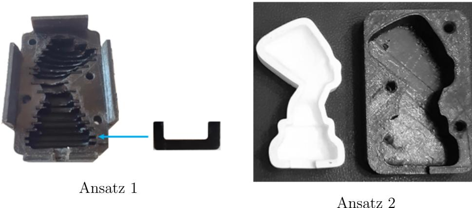
Abb. 224: 3-D gedruckte Verpackungen zur Halterung der Nofretete-Nachbildung (Abbildung 219), [209]
