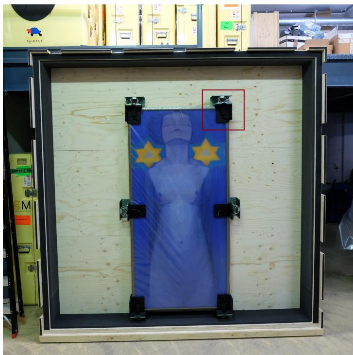
Abb. 259: Rechtes Gemälde in der spezifisch konstruierten und hergestellten Transportkiste, Foto: Kjeld Slingerland
