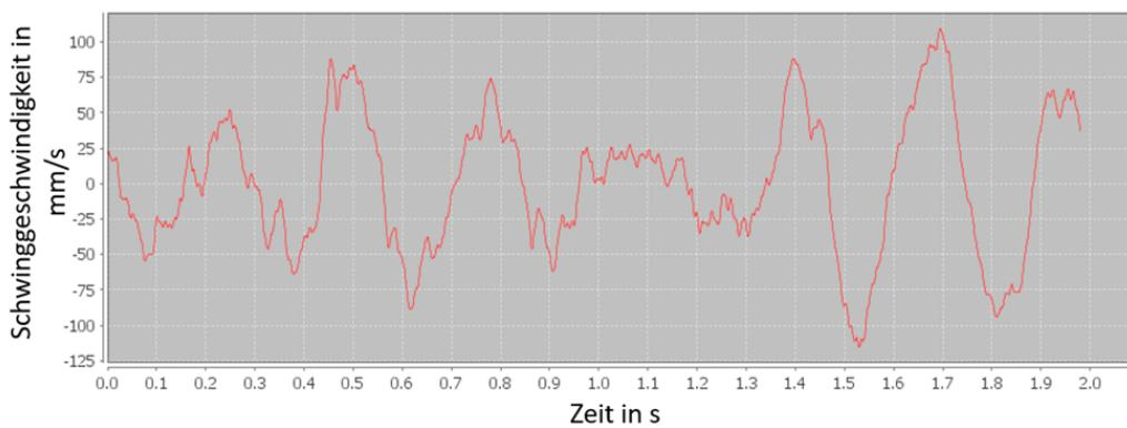
Abb. 143: Schwinggeschwindigkeiten der LKW-Ladefläche in transversaler Richtung (quer zur Fahrtrichtung)
