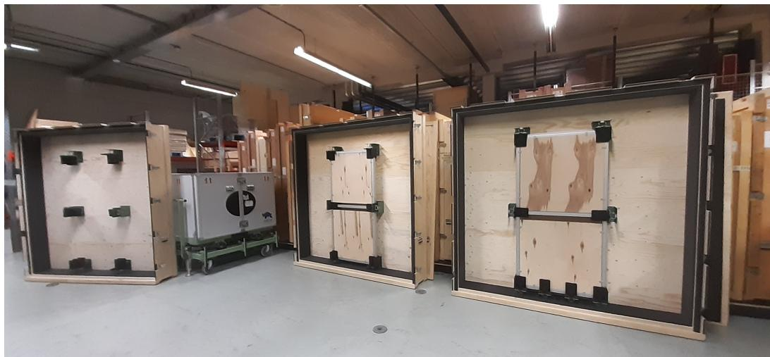
Abb. 258: Gewichtsäquivalente Dummies in „Evolutions“ Transportkisten zur Überprüfung der Wirksamkeit der Schockabsorption und Schwingungsisolation im Depot von Hizkia van Kralingen, Den Haag
