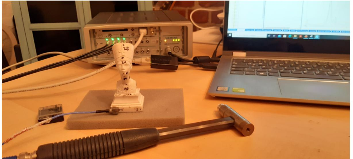
Abb. 222: Versuchsaufbau für die experimentelle Modalanalyse an einem Duplikat der Nofretete-Nachbildung
