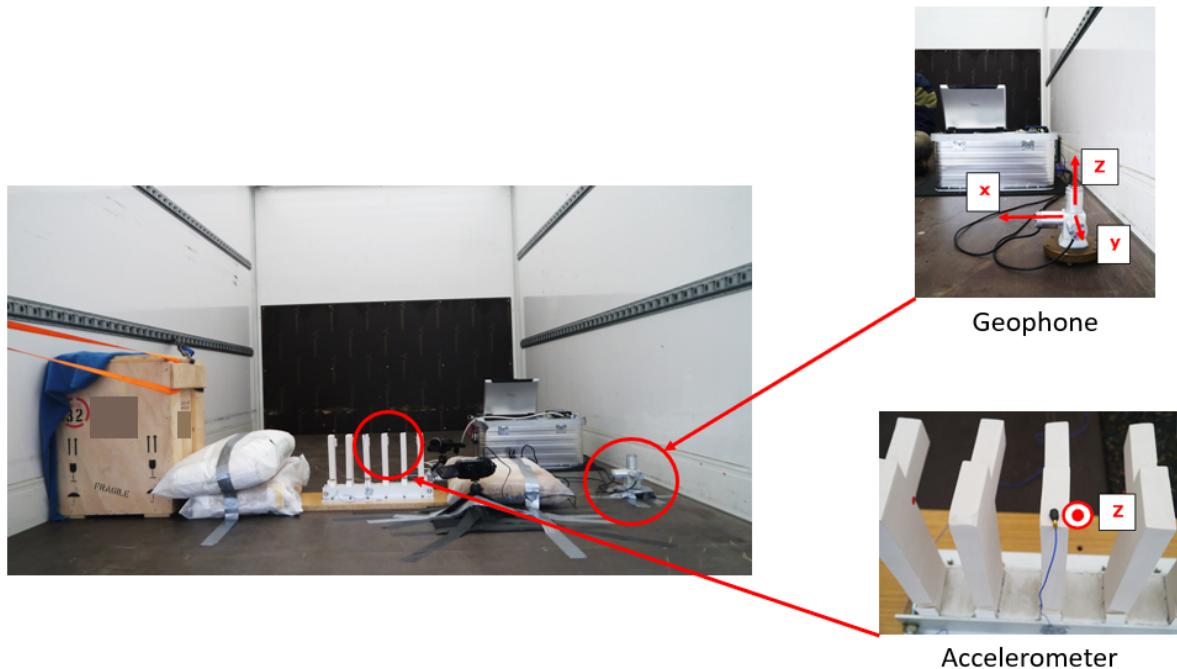
Abb. 214: Versuchsaufbau für die Betriebsschwingungsanalyse während eines innerstädtischen Realtransports [43], Foto: G. Eichmüller
