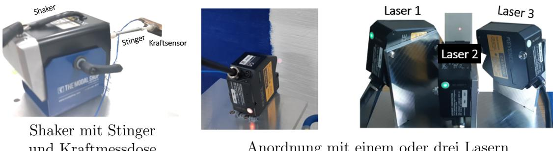
Abb. 55: Im Gemäldeprüfstand verwendete Geräte für die Anregung und Antwortmessung
