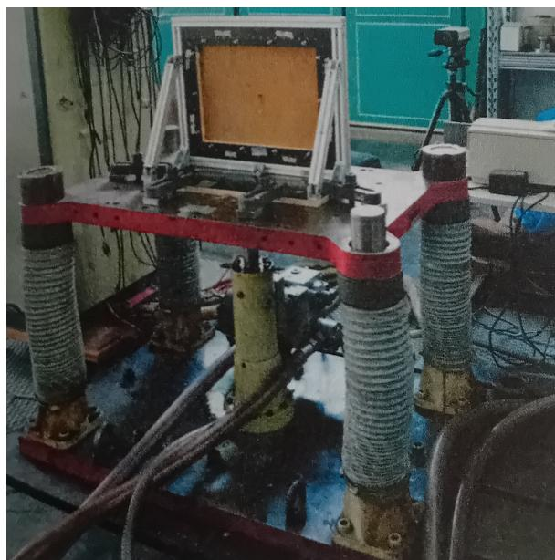
Abb. 51: Hydropulsanlage mit Testgemälde an der TU Berlin, Quelle: [195], S. 35
