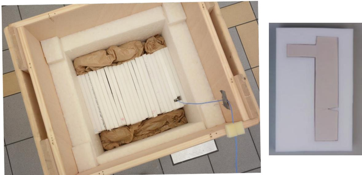
Abb. 213: Realisierte Transportkiste, Quelle: [43]
